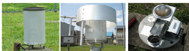
転倒ます型雨量計
