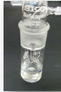
図 4.2. 反応後のエアロゾル捕集に使用した Bio Sampler®(SKC).
