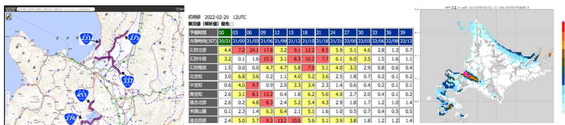
図 2：（左）21 日 6 時時点の通行止め。電子地形図（タイル）を加工して作成。（中）飛雪流量帳票アプリ。気象庁メソスケールモデルの 2022 年 2 月 20 日 12UTC 初期値から飛雪流量の予測値を計算している。飛雪流量は 5\text{km} 間隔の格子ごとに計算しているが、帳票に表示しているのは「市町村等をまとめた地域」区分内の格子から上位 20%の値を持つ格子を取り除いたあとの最大値（80 パーセンタイル値）である。（右）飛雪流量平面図アプリ。21 日 6 時の飛雪流量予測値。 5\text{km} の格子間隔ごとに計算された飛雪流量値を表示している。
