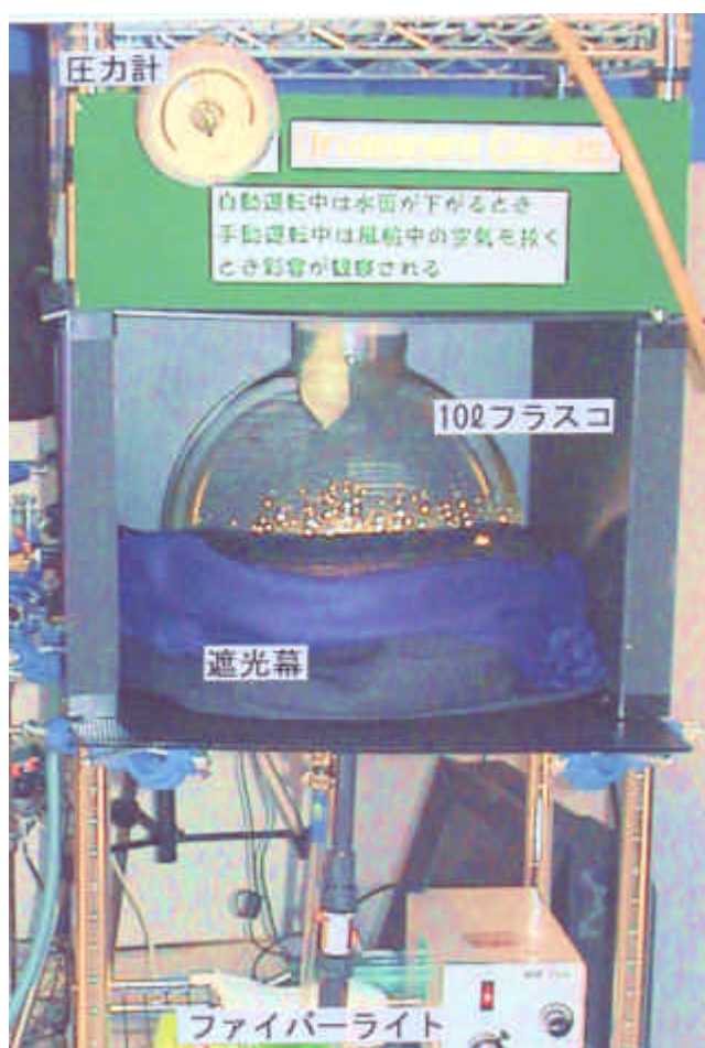
図 9 自動白雲彩雲発生装置 (水流を利用して減圧する)
