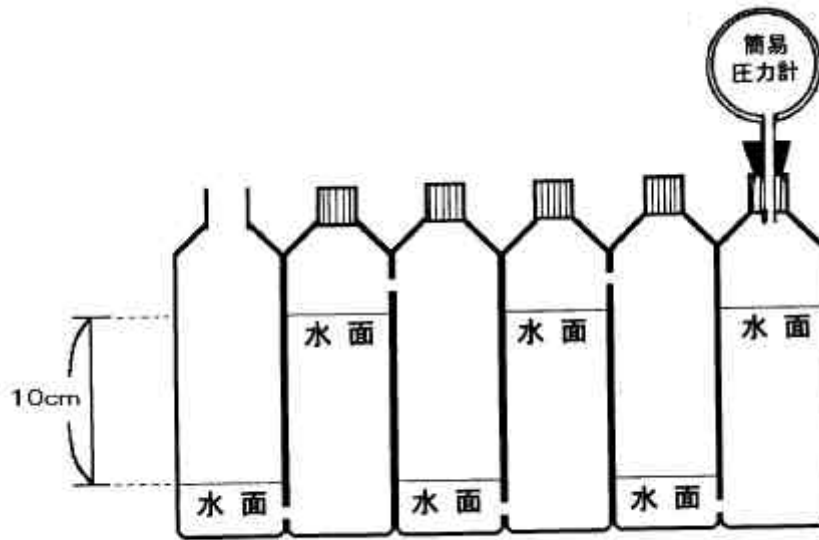
図8 6連ペットボトル(問題: 気圧が1000hPaの室内で図中の圧力計のおよその指示値を答えよ)
