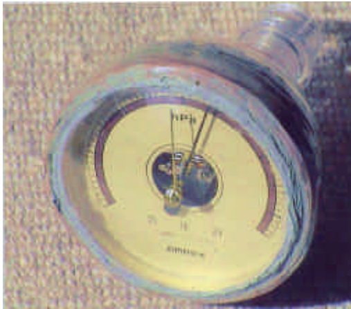
図5 簡易圧力計（アネロイド気圧計あるいは高度計をペットボトルに封入したもの）
