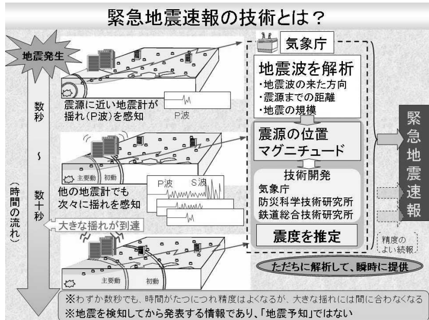
図3 緊急地震速報の技術イメージ。緊急地震速報の震源精度は時間経過と共に向上するが、大きな揺れに間に合わなくなる。
